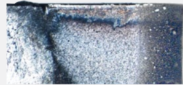
Techniks CNMG insert - After 22 min.
