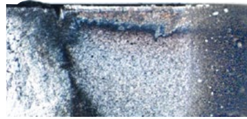
Techniks CNMG insert - After 22 min.
